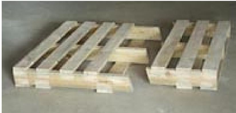
Enlever une latte et faire la découpe en biais (voir plan) sur les trois tasseaux de la palette avec une scie sauteuse et une scie à main. Fixer sur l'assise les pieds du fauteuil (voir plan).
