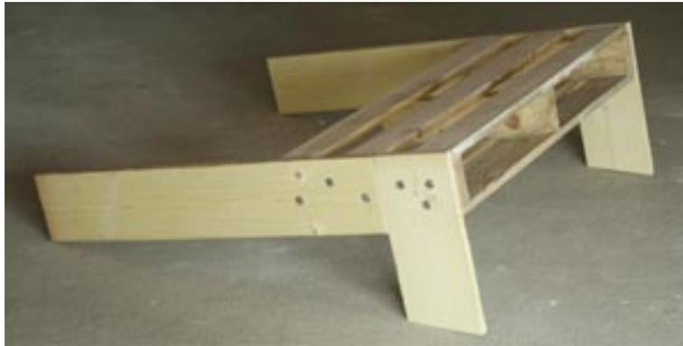
Fixer chaque pied grâce à deux ou trois vis. Une fois l'assise réalisée, scier les montants du dossier pour éviter qu'il ne dépasse. Insérer le dossier le long de l'assise. Fixer de chaque côté une vis pour bloquer le dossier.
