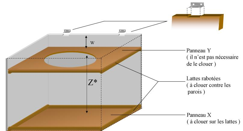
\* Z dépend de la hauteur de votre seau. Si le seau est moins haut, on relèvera la plaque du fond (le panneau X). Attention, w doit être le plus petit possible, compatible avec les dimensions de l'attache de la hanse du seau.
