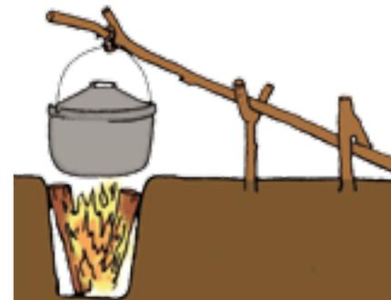
**Construction :** un trou en terre de la forme et de la dimension d'un seau ordinaire.
